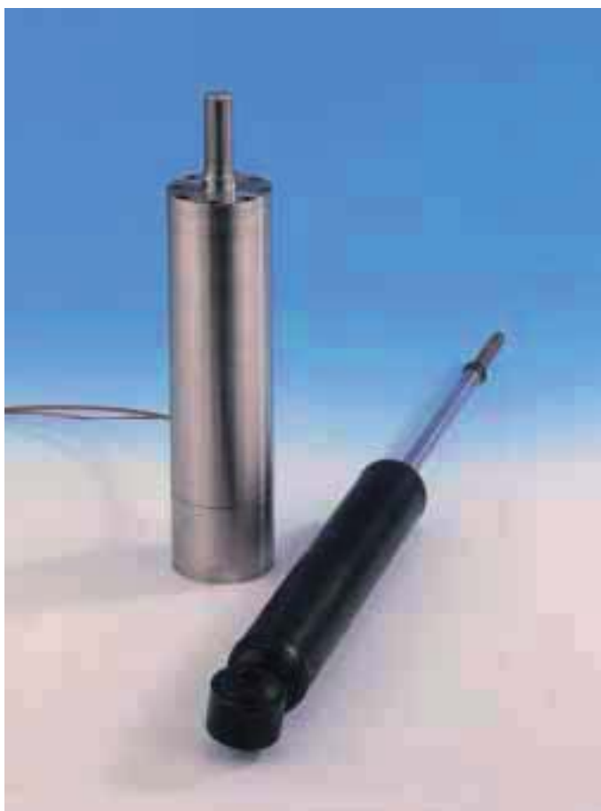
Fig.16: アクティブな振動キャンセルのための、大断面の特注設計されたアクチュエーター、100kニュートンの非常に高い負荷、56mmの直径
