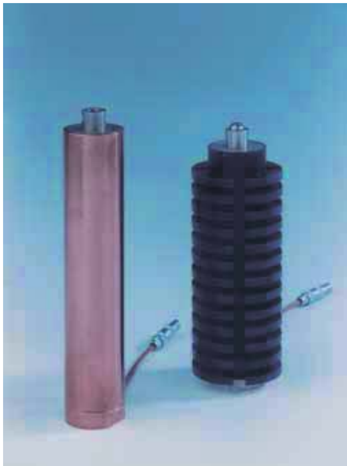
Fig.15: "ThermoStable"のテクニックを使用したアクチュエーターの熱対策のための異なった構成。 左側:銅のケーシングが使われたアクチュエーター 右側:強制空冷装置のための空冷フィンがあるアクチュエーターケーシング
