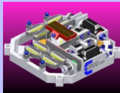
図4.7: ロゼッタ/ミダスインスツルメント仕様をパスした圧電素子のXYZステージ (IDEAS CAD出力)
