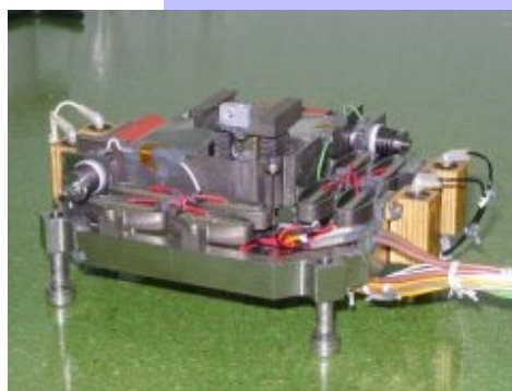
図4.8: ロゼッタ/ミダスインスツルメント仕様をパスした圧電のXYZステージ
