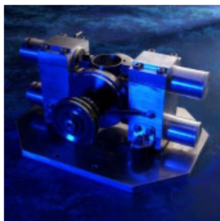
図 3.4: トルク 2N.mを発生することの出来るロータリーピエゾアクティブモーターのプロトタイプ
