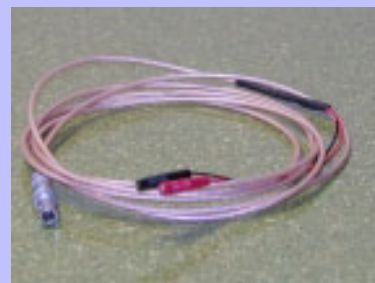
図8.3: APAアクチュエータ駆動用 標準同軸ケーブルRG178B/U
